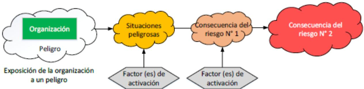
Figura A-3: Peligro único con múltiples factores desencadenantes para producir riesgo (s) de seguridad operacional
