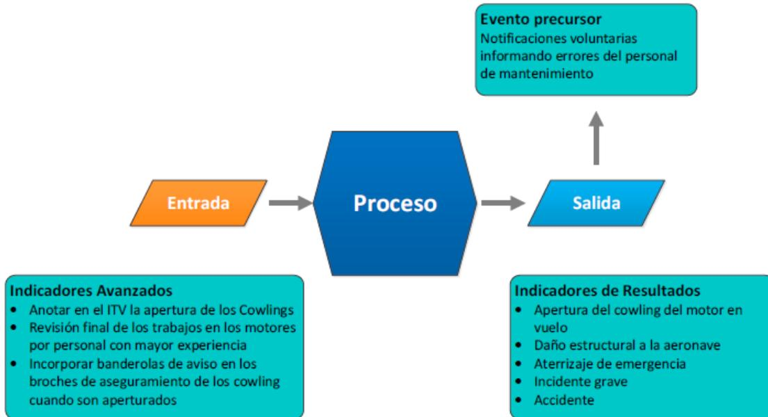
Figura 5. Indicador avanzado versus indicador de resultado
