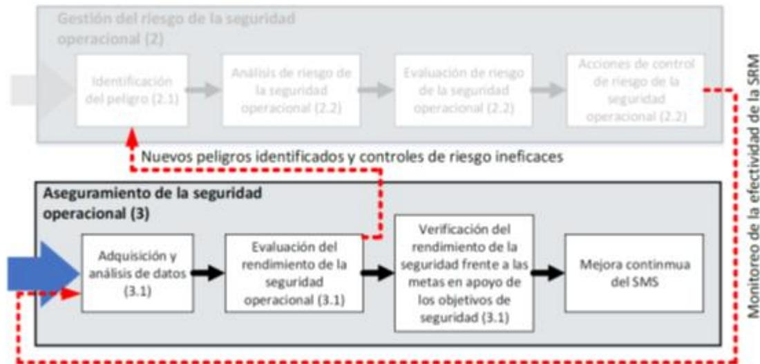
Figura 4. Pasos del aseguramiento de la seguridad operacional
